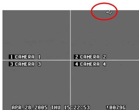
1) После подключения записывающего устройства к порту USB на экране загорается соответствующий индикатор, как показано слева.
