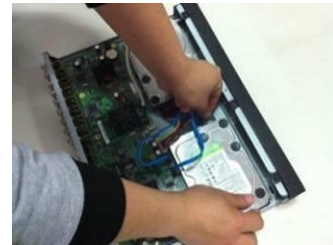
Падключыце SATA кабель і кабель харчавання на ніжняй і задняй частцы корпуса і зачыніце корпус верхняй вечкам.
