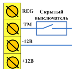
Рис. 8.2. Схема подключения скрытого выключателя
