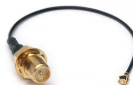
Рисунок 6.2 — Пример антенного переходника U.FL-SMA
