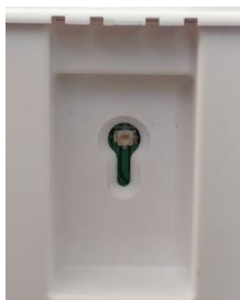
Рисунок 6.1 — U.FL-разъем для подключения GSM-антенны
