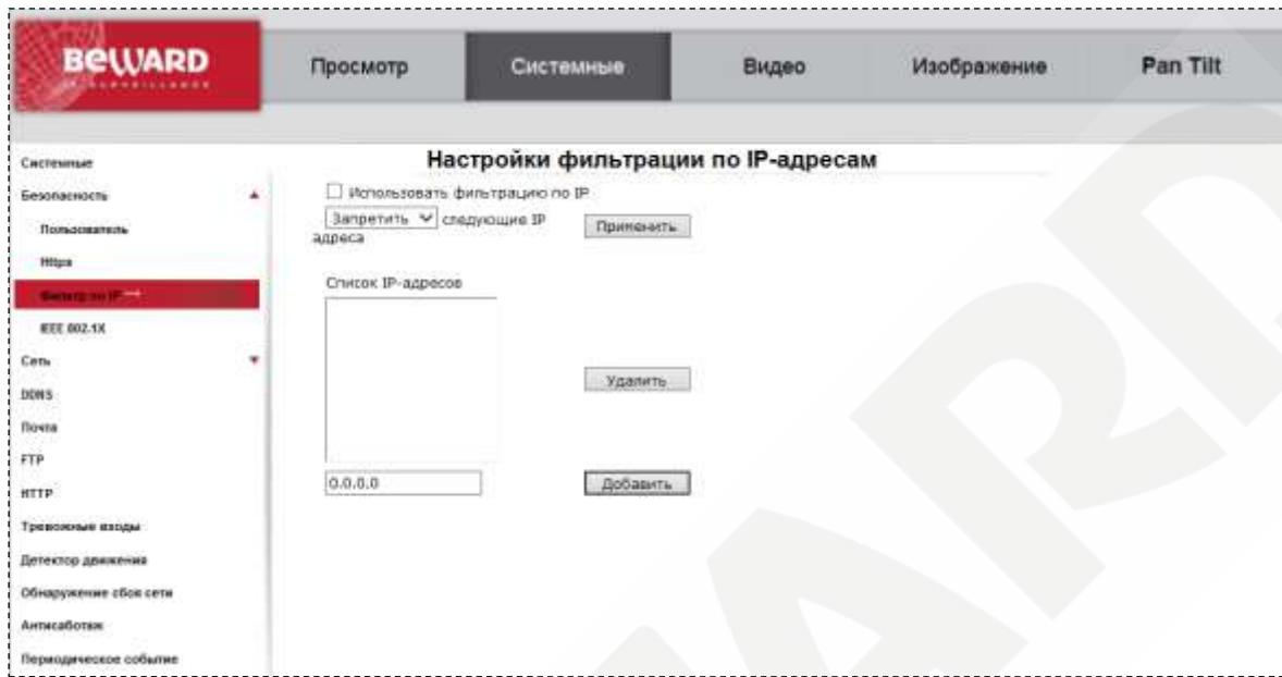
**Использовать фильтрацию по IP (Enable IP filter):** установите галочку напротив данной строки, если Вы планируете использовать функцию фильтрации по IP-адресам. Доступно два режима работы IP-фильтра:
