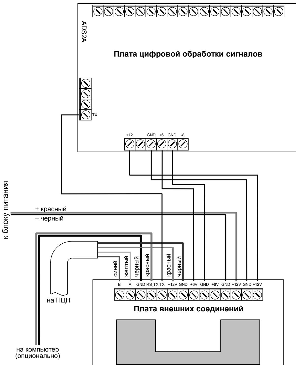
Выход на компьютер подключать необязательно. Этот выход нужен только при проверке БС и при сборе статистики прохождения радиосигналов с объектов.
