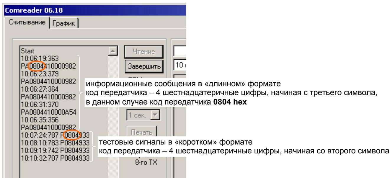
После передачи всех сообщений о состоянии передатчика на момент включения, передатчик переходит в дежурный режим, в котором примерно раз в минуту будет передавать один тестовый сигнал.
