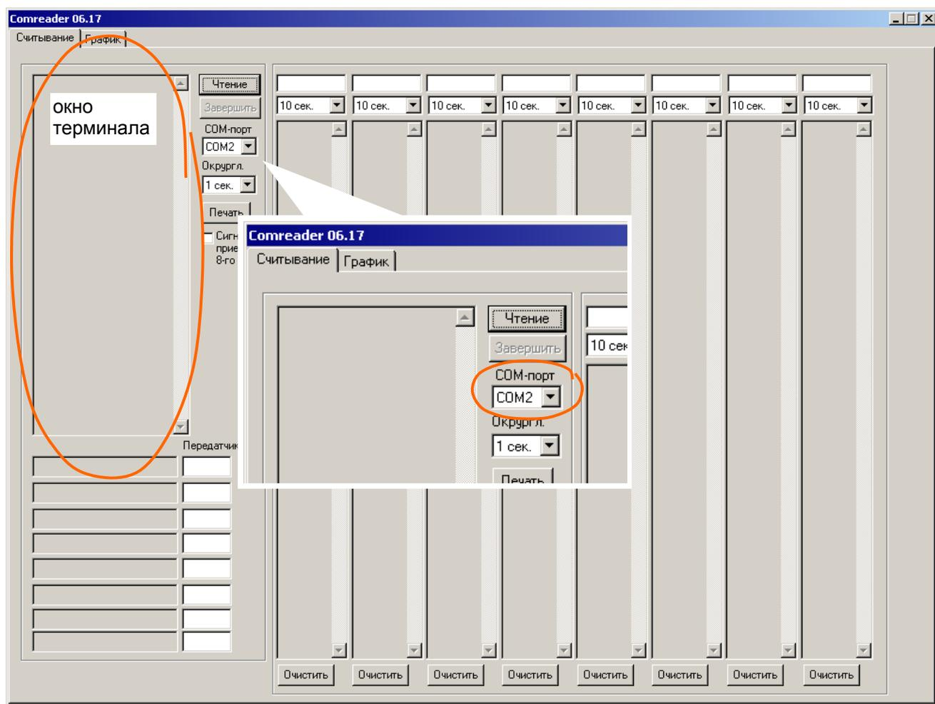
Кликните по кнопке *Чтение*. В терминальном окне программы будет выведена надпись *Start*, после чего каждые 4 с должны начать выводиться сигналы P0000T7D, предназначенные для контроля связи между БС и ПЦН.
