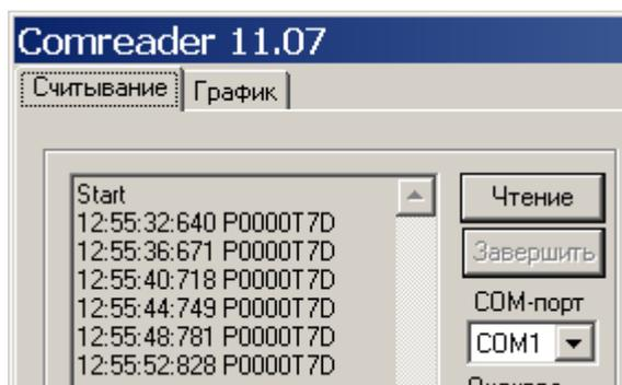
Если контрольные сигналы не выводятся, то либо неправильно подключен или спаян кабель, либо неисправна БС, либо неисправен COM-порт компьютера.
