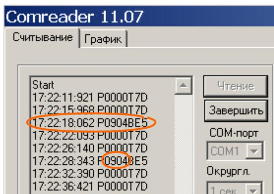
Выключите передатчик, переведите его переключателями в рабочий (охранный) режим и включите. Передатчик в рабочем режиме сразу после включения питания передает пакет радиосигналов с сообщением о включении. Если шлейфы нарушены, то будут переданы еще несколько пакетов сигналов о тревоге.
