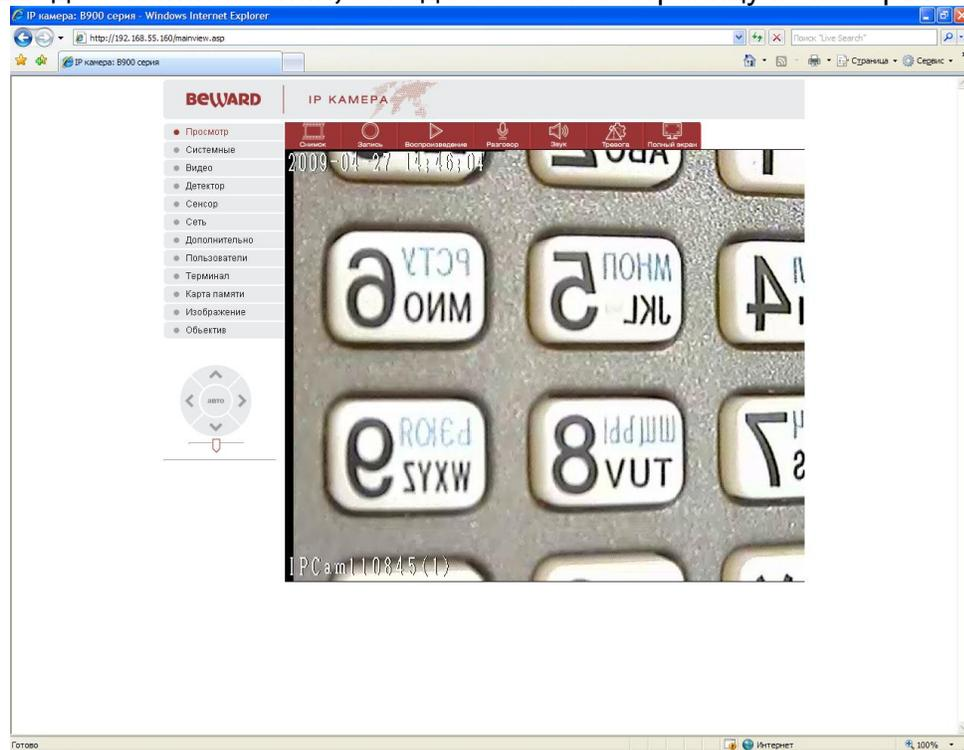
Перед нами домашняя страница настроек оборудования. При этом в правой части находится изображение, получаемое с IP-видеокамеры или IP-видеосервера, а в левой части – меню настроек. Вверху находятся кнопки вызова дополнительных функций, на изображении отображается дата, время (в левом верхнем углу) и имя камеры (в левом нижнем углу). Если изображение нечеткое – настройте объектив до получения четкого изображения.
