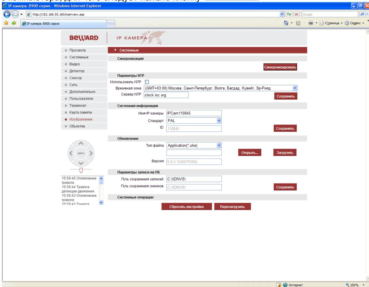
Здесь же устанавливаются параметры функции NTP – Network Time Protocol. С ее помощью можно задать автоматическую синхронизацию внутренних часов камеры с сервером точного времени в Интернет.
