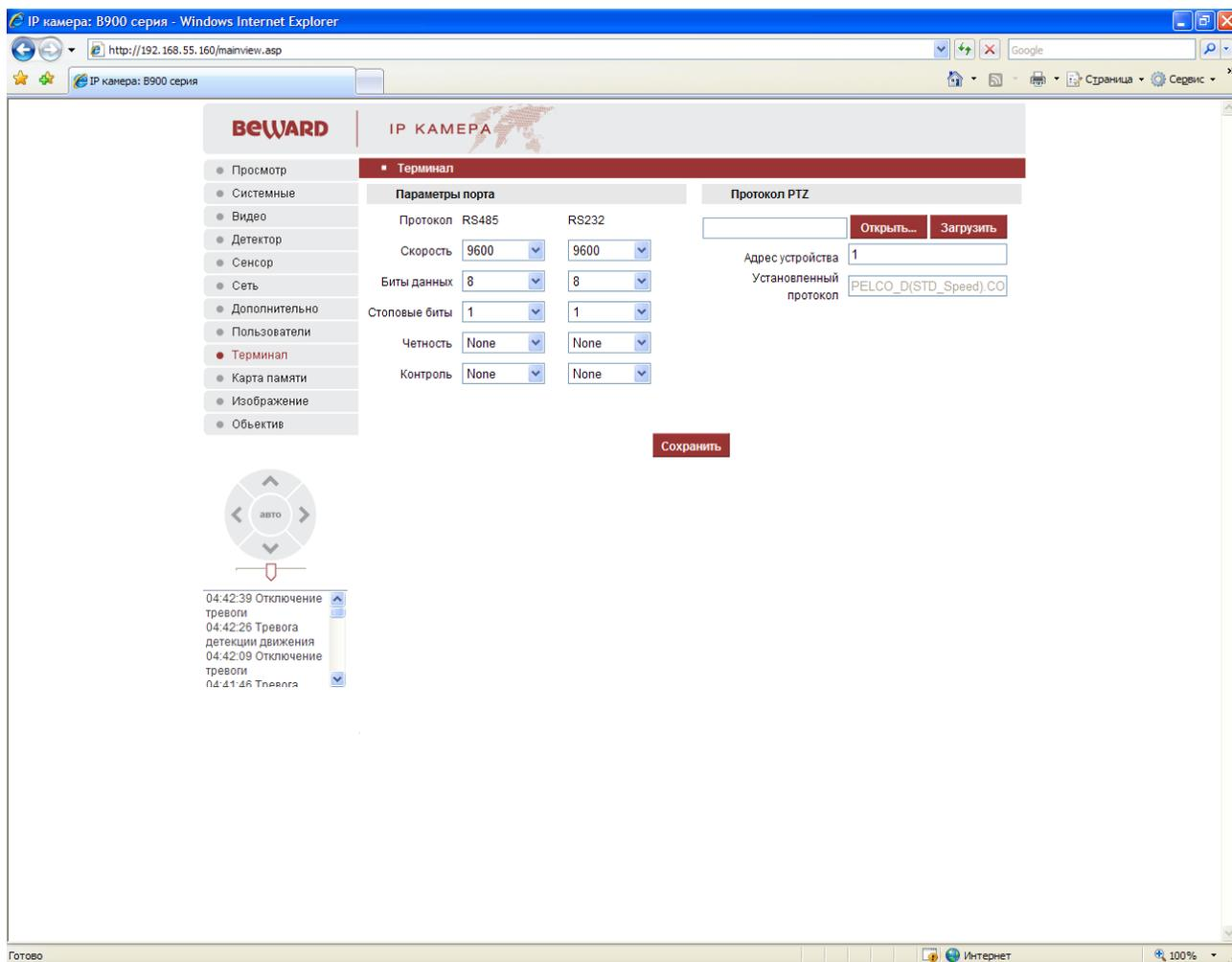
Для управления поворотным устройством необходимо подключить контакты интерфейса RS-485 или RS-232 к контактам RS-485 на задней стенке видеосервера В-700, или камеры серии В-900 в соответствии с инструкцией по эксплуатации подключаемой камеры.
