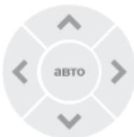
Ниже этих кнопок расположены элементы управления движением камеры. Соответственно, при нажатии на стрелки камера движется вверх, вниз, влево и вправо. Центральная кнопка включает движение камеры по заранее записанному маршруту по установленным пресетам.
