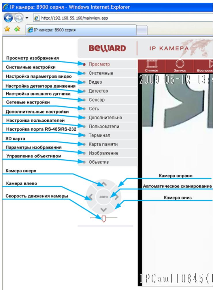
Все пункты меню, кроме управления объективом, управления поворотным устройством и скоростью движения камеры относятся к настройкам как IP-видеокамер серии В-900, так и к настройкам IP-видеосервера В-700.
