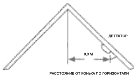
Рисунок 9. Рекомендуемое размещение детектора в помещениях с наклонными стенами
