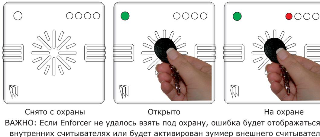
Существует два типа считывателей: внутренний, для работы только внутри помещения и внешний, для работы как внутри помещения, так и на улице.
