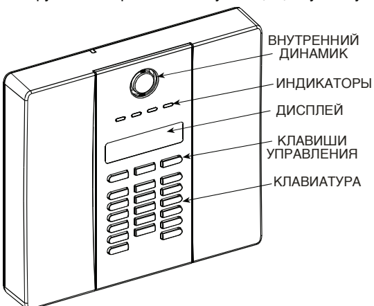
Рисунок 1. Панель управления с закрытой крышкой
